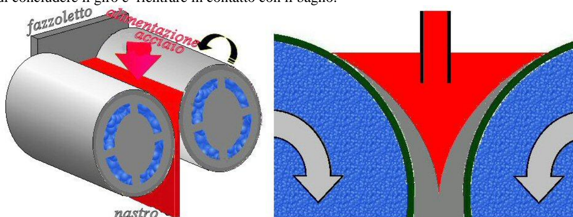
Figura 11.16 – Schema dell'impianto di colata a nastro twin roll con la formazione dello strato solido a contatto con i cilindri.
