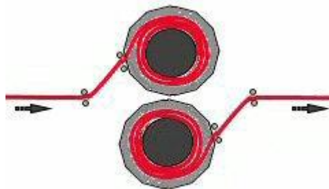
Figura 11.14 – Forni di avvolgimento Cremona box tra la colata continua ed il laminatoio
