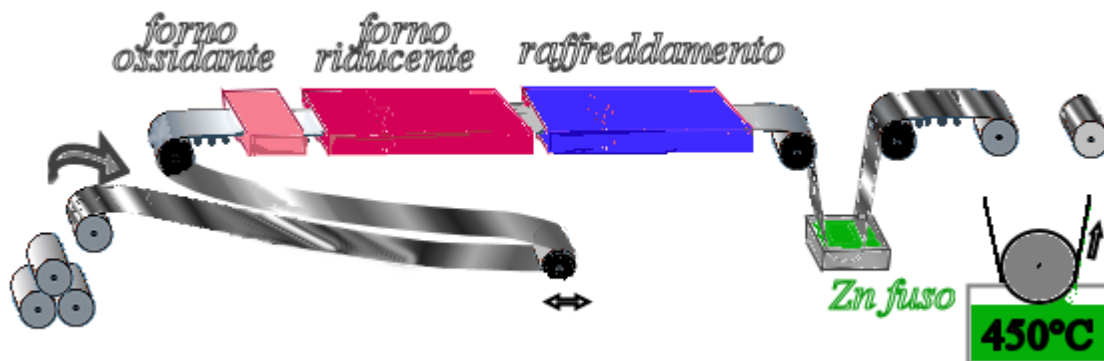
Figura 14.13 – Schema di impianto per la zincatura continua per hot dipping
