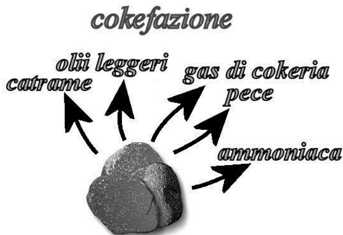
Figura 2.12 – Prodotti ottenibili nella fabbricazione del coke
