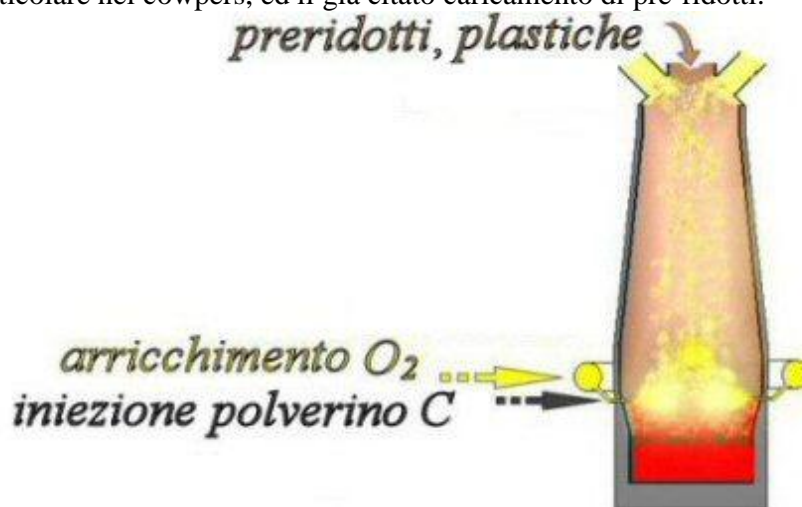
Figura 3.11 Interventi sull'altoforno per ridurre l'emissione di CO 2 nel complesso dello stabilimento a ciclo integrale.
