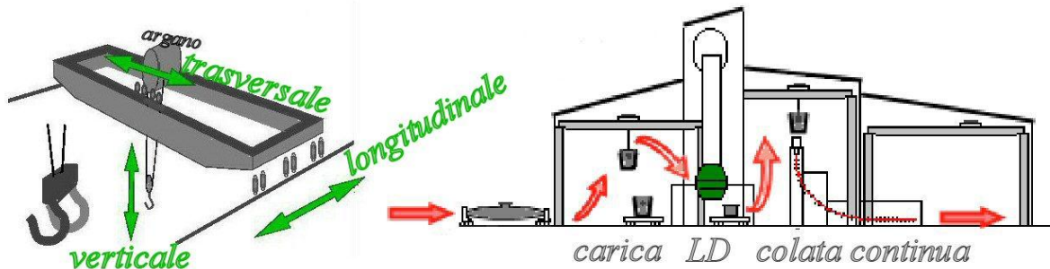
Figura 5.6 – Schema della sezione trasversale di un'acciaieria LD con il flusso di ghisa e di acciaio allo stato liquido tra le diverse campate. Sulla sinistra sono indicati i movimenti indipendenti realizzabili mediante carroponte
