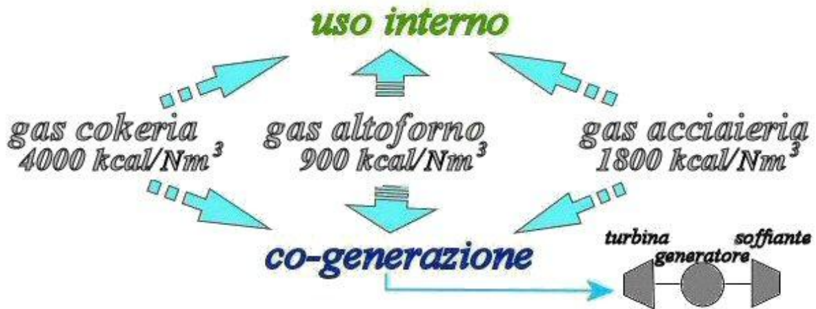
Figura 3.6 Schema di utilizzo dei gas in un impianto a ciclo integrale
