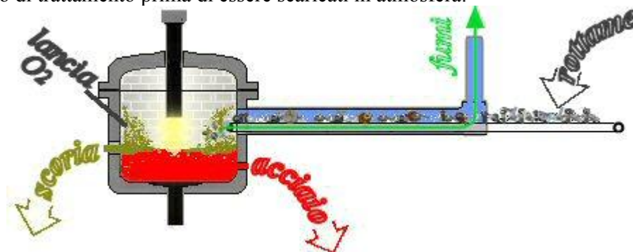
Figura 6.15 – Forno elettrico ad arco monolettrodo con alimentazione continua di rottame e preriscaldato, preriscaldati nel convogliatore dai fumi in uscita
